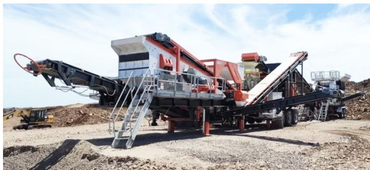
Ilustracija postrojenja za tretman neopasnog građevinskog otpada
